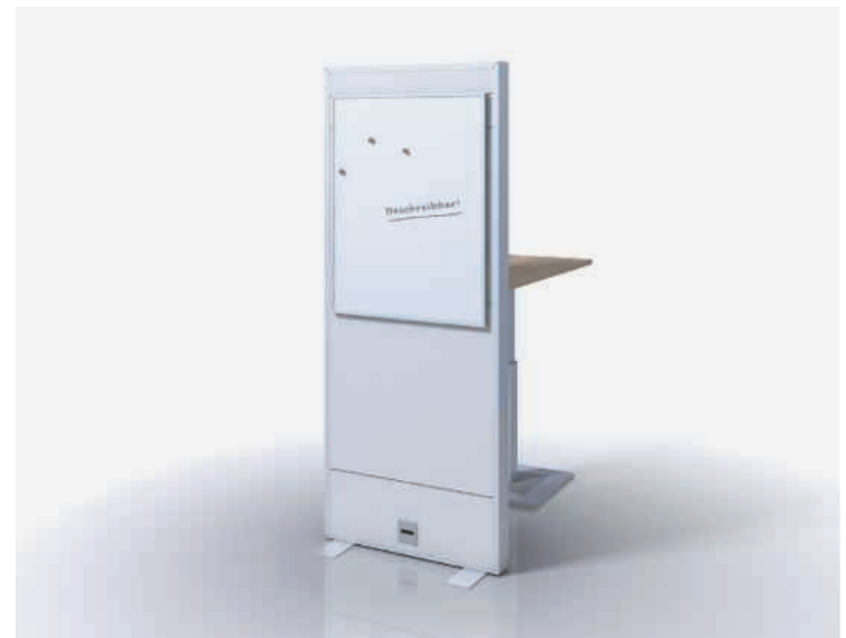
Monitor-Terminal mit Stehtisch Alurahmengerüst mit Fußplatten; Systemschienen auf beiden Seiten; Frontplatte mit Kabeldurchlassbuchse; Rückwandplatte zum Öffnen und Elektrifizieren; Stehtisch zum Einhängen, Höhe 1080 mm
