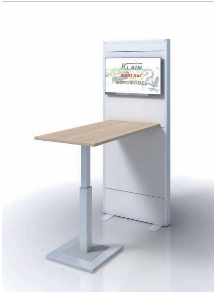
Monitor-Terminal mit Stehtisch Alurahmengerüst mit Fußplatten; Systemschienen auf beiden Seiten; Frontplatte mit Kabeldurchlassbuchse; Rückwandplatte zum Öffnen und Elektrifizieren; Stehtisch zum Einhängen, Höhe 1080 mm
